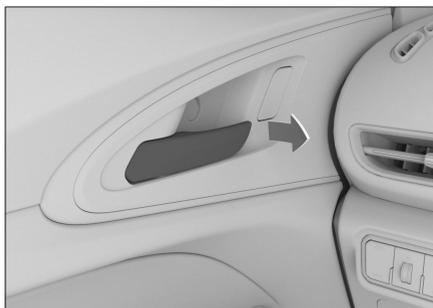
在车门锁止状态下，拉动车门内扣手解锁车门，再拉动一次可打开车门。
