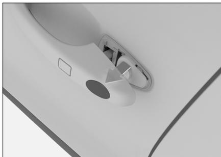
2. 将机械钥匙插入车门锁孔内，转动钥匙，可以锁止或解锁车门。
