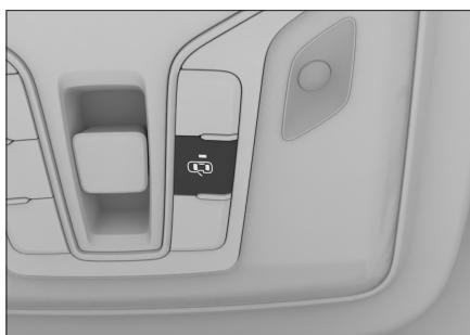
按压门控按钮，可以开启或关闭门控功能。
