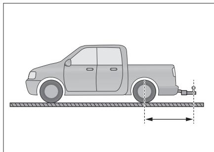
牵引装置后悬是指被允许的牵引装置连接点中心与牵引车辆后轴中心线之间的水平距离。
