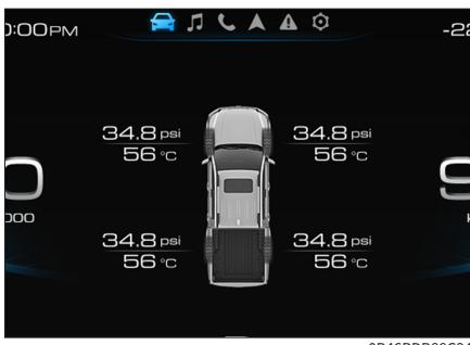
按压方向盘上的 ◀ 或 ▶ 按钮，将仪表界面切换至 ⚡ 行驶数据界面，然后按压 ▲ 或 ▼ 按钮，切换至胎压监测界面，可以查看四个在用轮胎的压力和温度信息。
