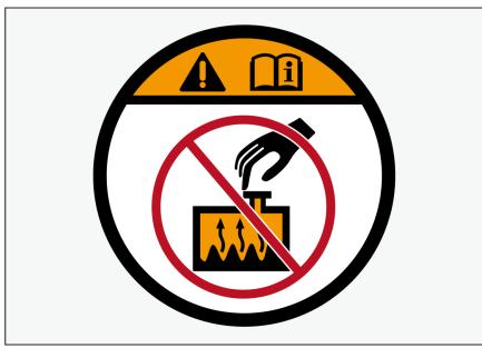
该标贴位于散热器盖上，用于提示您发动机处于过热状态时，不要打开散热器盖。否则，可能造成烫伤或有冷却液溅出的危险。
