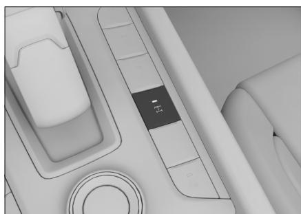
启动车辆，按压 前桥差速锁按钮，可以使差速锁锁止或解锁。
