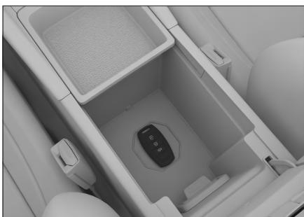
当车辆提示“钥匙是否在车内”时，可能是由于智能钥匙亏电造成车辆无法启动。此时请将钥匙放入前排扶手箱内的『
