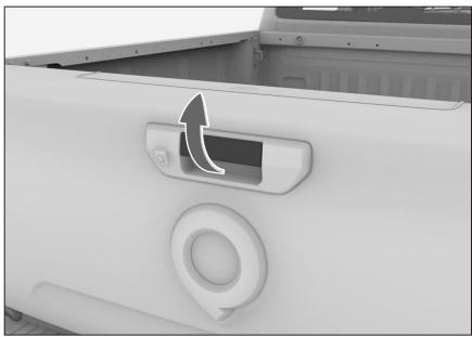
解锁驾驶员侧车门后，再拉动货箱门把手，即可打开货箱门。
