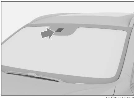
将电源模式切换至 ON 模式，ETC 设备自动开启，同时蓝牙功能开启。
