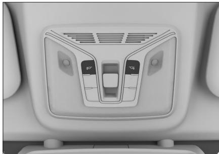
按压 左侧阅读灯开关或 右侧阅读灯开关，可以开启或关闭相应的阅读灯。
