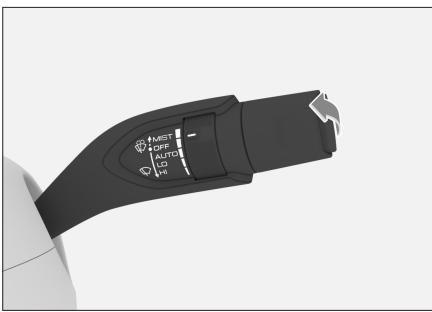
将雨刮控制组合开关拉向自身并保持住，前雨刮将使用风窗洗涤液刮刷前风窗玻璃。松手后，组合开关自动回位。
