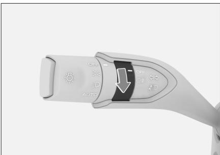
近光灯处于点亮状态时，反复将雾灯开关旋至 后雾灯位置，可以开启或关闭后雾灯。松手后，旋钮自动回位。
