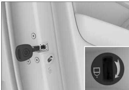
副驾驶侧车门和后排车门都配有车门紧急锁止装置。
