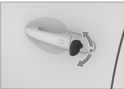
使用机械钥匙插入车门锁孔内，转动钥匙，可以锁止或解锁车门。
