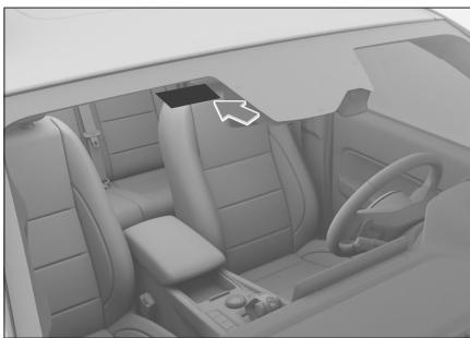
微波窗口推荐位置用于粘贴电子标识。电子标识应正面朝向机动车正前方，并采用粘贴方式附着于汽车前风窗玻璃内侧。
