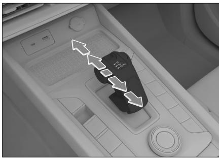
向前或向后拨动换挡杆 1 格或 2 格，可切换不同挡位，松开换挡杆后将自动回位。仪表上会显示对应的挡位。
