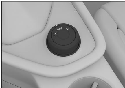
转动旋钮使指示灯对准某个模式，当指示灯常亮时，表示驱动模式切换完成。指示灯闪烁时，表示驱动模式正在切换中。
