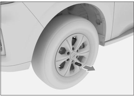
装配车轮螺母装饰罩的车辆，需先用随车附带的车轮螺母装饰罩拆卸工具将螺母装饰罩依次取下。
