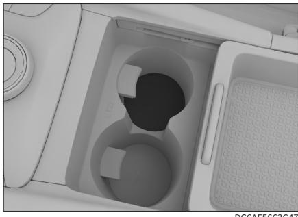
3. 在盖板缺口处，使用布包裹的平头螺丝刀，将盖板撬开，即可见到 P 挡解锁手柄。
