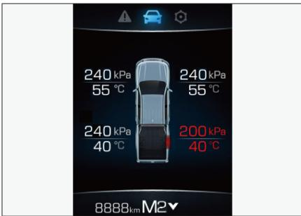
按压方向盘上的 ◀ 或 ▶ 按钮，将仪表界面切换至 行驶数据界面，然后按压 ▲ 或 ▼ 按钮，切换至胎压监测界面，可以查看四个在用轮胎的压力和温度信息。
