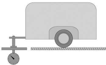
连接点静态垂直载荷是指车辆在静止状态下，挂车与牵引装置连接处能承受的垂直方向的最大载荷。
