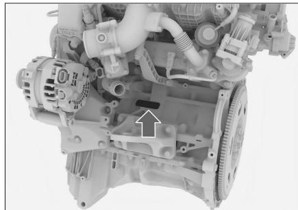
发动机编号刻印在发动机缸体上面，位置如图所示。
