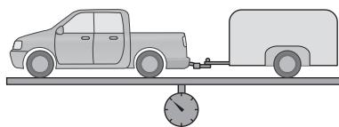
最大组合总质量是指牵引车（包括乘员和货物）、牵引装置和挂车（包括挂车和货物）允许的最大总质量。
