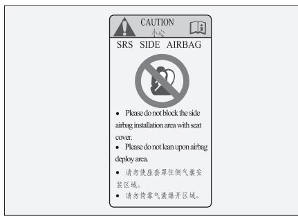
该标贴位于中央立柱上，用于提示您本车配备有侧面安全气囊，请注意相关事项。
