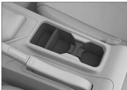
杯托中部的杯托夹可以向上取出。
