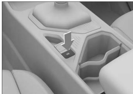
关闭驾驶员车门，系好驾驶员安全带，启动车辆后，按压 AVH 开关，可开启或关闭自动驻车功能。
