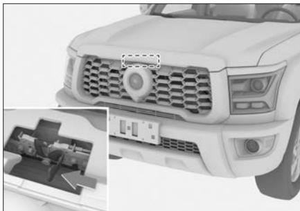
3. 将支撑杆从卡槽中取出后，将支撑杆前端插入机舱盖的凹槽里，固定住打开的机舱盖。
