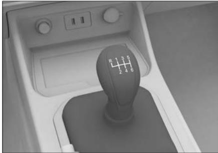
该变速器有倒挡（R）、空挡（N）和六个前进挡。
