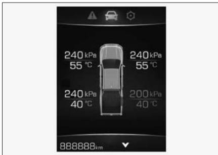
按压方向盘上的 返回按钮，将界面切换至 行驶数据，然后按压 上翻或 下翻按钮，切换至胎压监测界面，可以查看四个在用轮胎的压力和温度信息。
