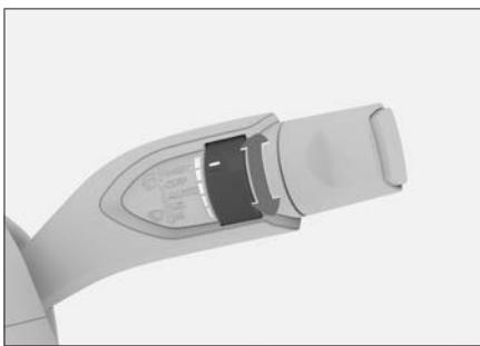
旋转调节旋钮可以改变雨量光线传感器对雨量的敏感度，从而改变雨刮在自动刮刷挡位时的刮刷频率。
