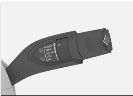
沿方向盘垂直方向拉起雨刮控制组合开关并保持住，前雨刮将使用风窗洗涤液刮刷前风窗玻璃。松手后，组合开关自动回位。
