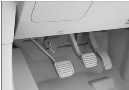
2. 将手伸进缝隙中，沿箭头方向拨动锁扣并抬起机舱盖。
