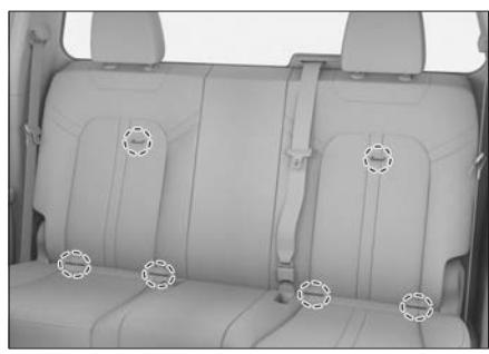
儿童座椅下部固定点有 4 个，位于后排座椅靠背及座垫之间的缝隙处。
