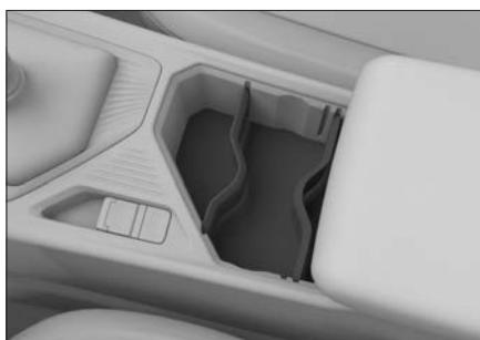
两侧的杯托挡板均可向上取出，一侧挡板可以调节杯托内径大小。
