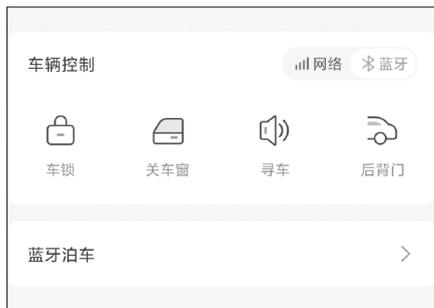
触摸【蓝牙】按钮，开启蓝牙钥匙模式，待蓝牙连接后，可使用蓝牙钥匙解锁或锁止车门、关闭车窗、寻车、开启或关闭后背门、实现蓝牙泊车。
