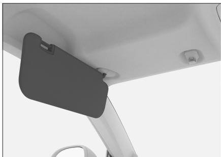
欲遮蔽侧面阳光时，翻下遮阳板，脱开挂钩并转至侧面。
