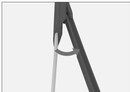
按压弹性扣片的同时沿图示箭头方向拉雨刮片，直至其从雨刮臂上脱开。
