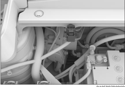
电池安全开关位于机舱内，打开机舱盖即可看到，用于断开或连接高压系统动力电源。
