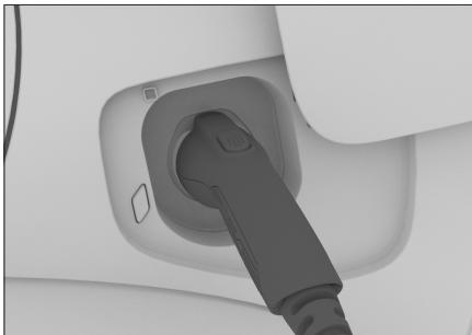
连接正常后，控制盒上电源指示灯及仪表上的 充电状态指示灯（红色）点亮。
