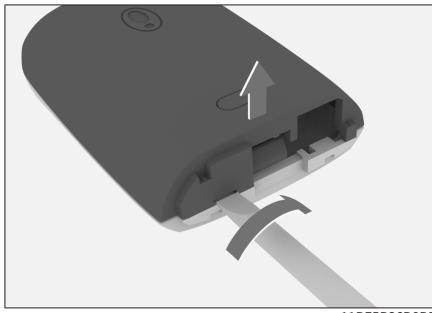
3. 取出旧电池，将新电池装入槽内。
