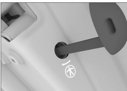
按箭头方向旋转机械钥匙可开启儿童锁。反向旋转可关闭儿童锁。
