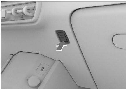
沿箭头方向按压行李钩盖板即可使用，只可悬挂重量较轻的物品，且最大承重重量不得超过行李钩上标识的重量。行车前，应确认所有物品均已被固定牢靠。
