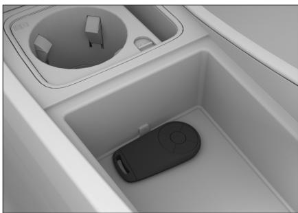
若车辆提示【请确认钥匙是否在车内】时（例如：智能钥匙亏电；门护板或后保险杠严重损坏等情况），请将智能钥匙放入副仪表板储物盒内『』标识上方，满足车辆启动条件，踩下制动踏板即可。如还无法启动车辆，请立即联系服务商。
