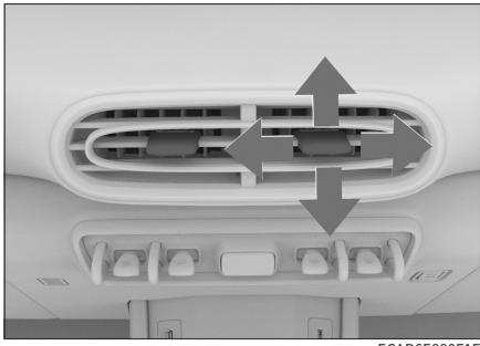
出风口中部有相应的控制拨片，拨动出风口中部的拨片，可以调节气流方向。
