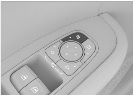
按压儿童锁开关后，将无法使用内扣手开启后排两车门，且无法使用后排车门上的车窗开关控制相应车窗。
