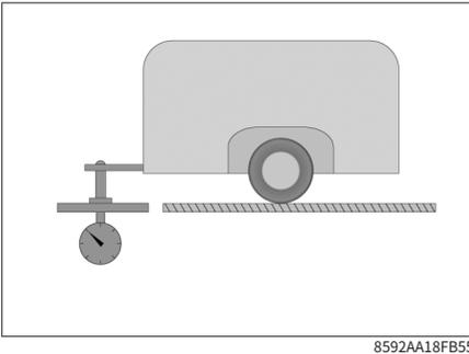
连接点静态垂直载荷是指车辆在静止状态下，挂车与牵引装置连接处能承受的垂直方向的最大载荷。
