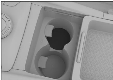
3. 在盖板缺口处，使用布包裹的平头螺丝刀，将盖板撬开，即可见到 P 挡解锁手柄。
