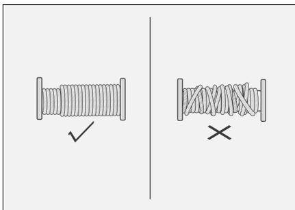
整理绞绳时，可通过绳钩带使绞绳保持一定的拉力，随绞绳收紧速度移动，使绞绳均匀紧密的缠绕好，当剩余 1 米左右时即可停止。
