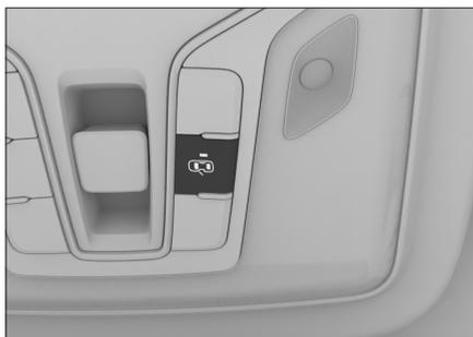
按压门控按钮，可以开启或关闭门控功能。开启门控功能后，阅读灯将根据车门状态自动开启或关闭。
