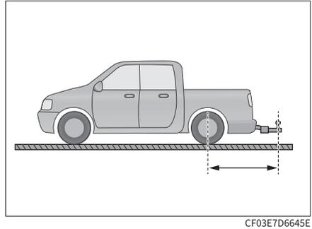
牵引装置后悬是指被允许的牵引装置连接点中心与牵引车辆后轴中心线之间的水平距离。
