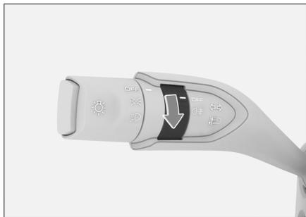
近光灯处于点亮状态时，反复将雾灯开关旋至
