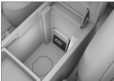
向上拉起储物盒内的通风阀门可将其打开，向下按压可将其关闭。
