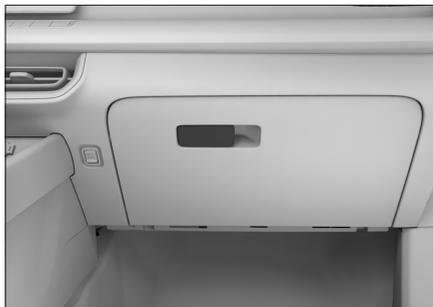
拉动储物箱上的扣手，向下翻转打开储物箱。
