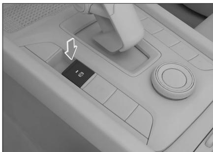
电源处于 ON 模式时，踩下制动踏板，按压 EPB 开关，即可释放驻车制动。
