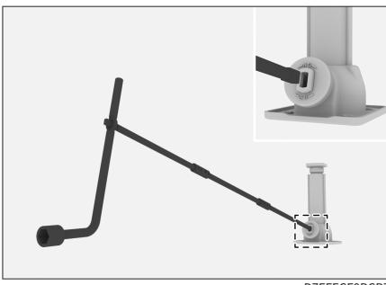
将备胎升降器摇杆前段、中段、后段及车轮螺母扳手组合成如图所示的形式。然后将备胎升降器摇杆插进千斤顶端孔中。
