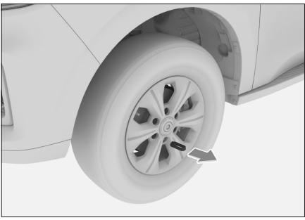
装配车轮螺母装饰罩的车辆，需先用随车附带的车轮螺母装饰罩拆卸工具将螺母装饰罩依次取下。
