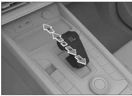
向前或向后拨动换挡杆 1 格或 2 格，可切换不同挡位，松开换挡杆后将自动回位。仪表上会显示对应的挡位。
