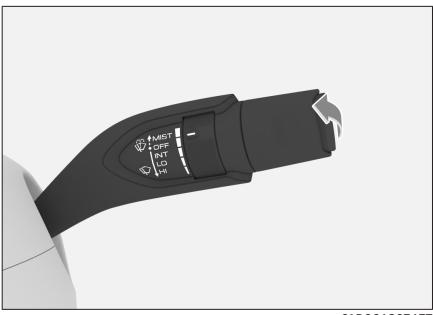
将雨刮控制组合开关拉向自身并保持住，前雨刮将使用风窗洗涤液刮刷前风窗玻璃。松手后，组合开关自动回位。
