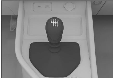
该变速器有倒挡（R）、空挡（N）和六个前进挡（1挡至6挡）。
