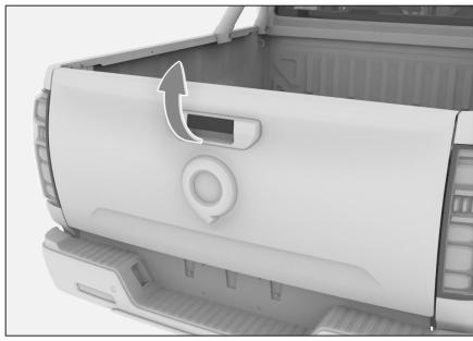
直接拉动货箱门把手，即可打开货箱门。
