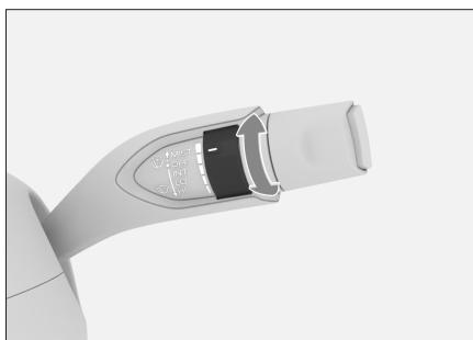
旋转调节旋钮可以改变间歇时间，从而改变雨刮在【INT】挡位时的刮刷频率。
