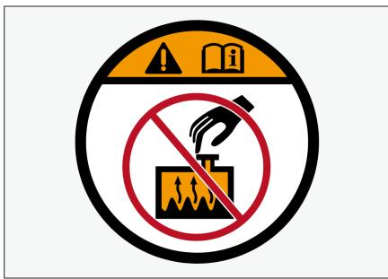
该标贴位于散热器盖上，用于提示您发动机处于过热状态时，不要打开散热器盖。否则，可能造成烫伤或有冷却液溅出的危险。
