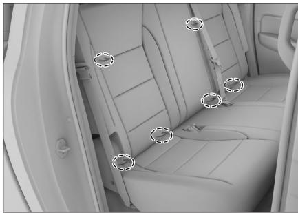
儿童座椅下部固定点有 4 个，位于后排座椅靠背及座垫之间的缝隙处。
