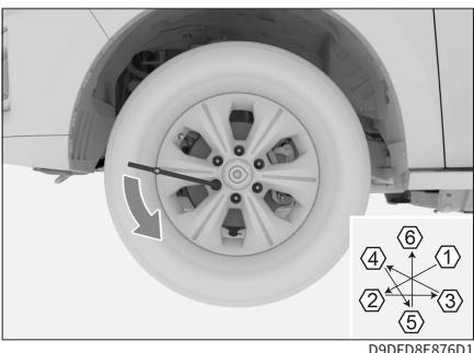
利用车轮螺母扳手，按照图示顺序逆时针稍微拧松螺母（大约1圈）。
