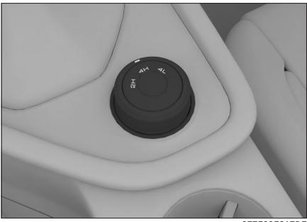
转动旋钮使指示灯对准某个模式，当指示灯常亮时，表示驱动模式切换完成。指示灯闪烁时，表示驱动模式正在切换中。
