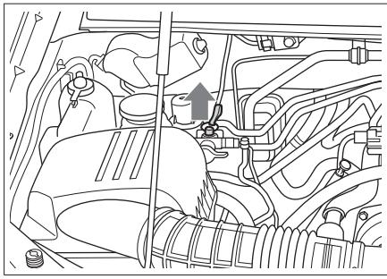
4. 将充气阀上的手动开关沿指向 OPEN 标记的箭头方向旋转到底，即可开始向气瓶内充气。
