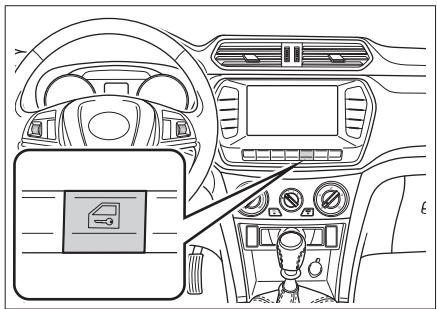
按压中控按钮可锁止所有车门。再次按压此按钮，解锁所有车门。
