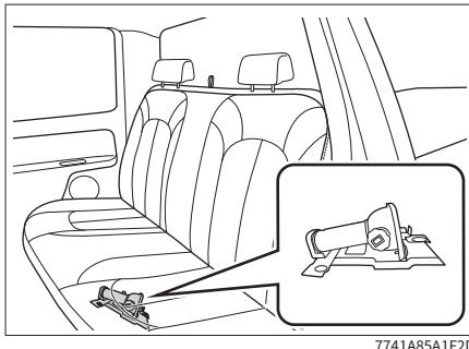
千斤顶放置在后排座椅左侧座垫下面。
