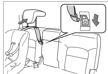
4. 锁定后排座椅靠背，将儿童座椅锁定机构滑入下部固定点，确保两个 ISOFIX 锁定机构正确固定。
