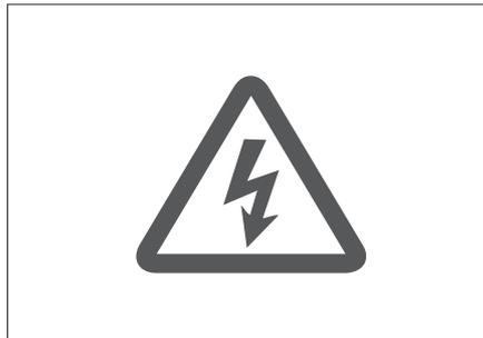
该标贴位于各高压零部件上，如充电口盖及充电机，用于提示您该部件内部为高压电，禁止擅自拆卸、维修或更换，请注意相关事项。否则，可能会有触电的危险。
