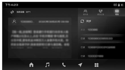
触摸【同步】按钮，可手动同步短信。
