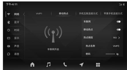
开启【车联网】：本机可通过车联网系统上网。
