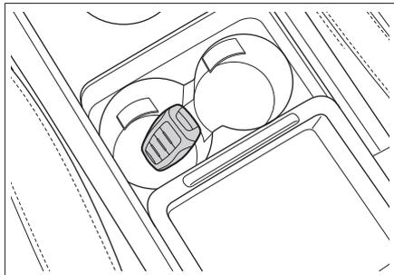
智能钥匙亏电等情况造成车辆提示“钥匙是否在车内”时，将智能钥匙放入前排杯座内的
