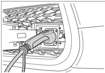
4. 将负载插入插排，打开插排电源开关。连接正常后，车辆开始放电，仪表上的放电连接指示灯点亮并显示放电信息。电源放电模式：220V/16A/50Hz
