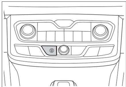
启动车辆后，按压 **C** 按钮或通过多媒体显示屏可以调出智能驾驶控制界面，设置前向辅助系统的灵敏度。
