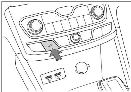
电源开关处于 ON 模式或启动车辆后，按压按钮，可以开启或关闭 HDC。
