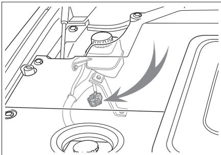
电池安全开关位于机舱内，用于断开或连接高压系统动力电源。
