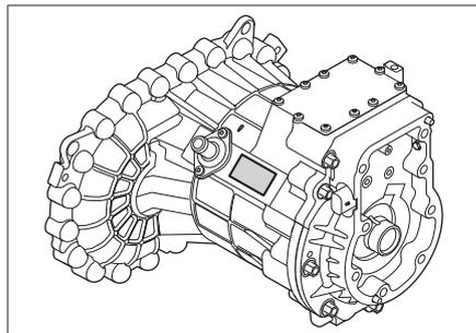
驱动电机编号刻印在其进水管旁边，位置如图所示。
