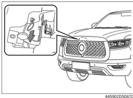
2. 按压充电枪上端的解锁按钮，将充电枪拔出。
