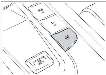
电源开关处于 ON 模式时，按压
