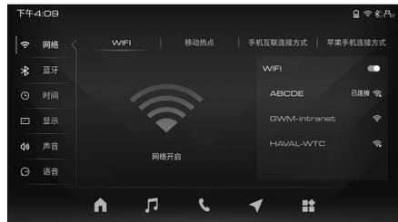
开启【WIFI】：开始搜索并显示搜索到的无线网络。触摸搜索到的网络名称，可连接该网络，若该网络为加密网络，需要输入正确密码才能进行连接。
