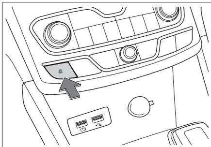
车辆启动后，按压
