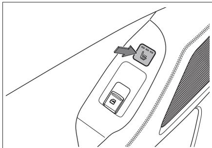
后排车门上各有一个座椅加热开关，可分别对后排座垫的左、右两侧进行加热。
