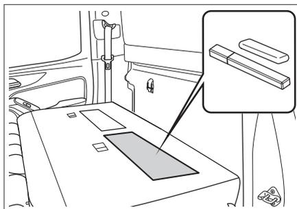
随车工具包、三角警告牌放置在后排座椅靠背后的布袋内。将后排座椅放倒后，即可看到。（▷ 第 47 页）
