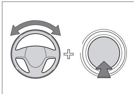
切换电源开关模式或启动车辆时，如果电源开关上的绿色指示灯闪烁，则表明转向锁解锁失败。此时，在左右轻轻转动方向盘的同时按压电源开关，即可解除锁定。
