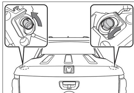
如图，拨动防雨棚的左右解锁装置后，即可手动打开防雨棚。
