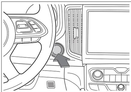
智能钥匙在车内时，直接按压电源开关，可以切换电源开关模式。
