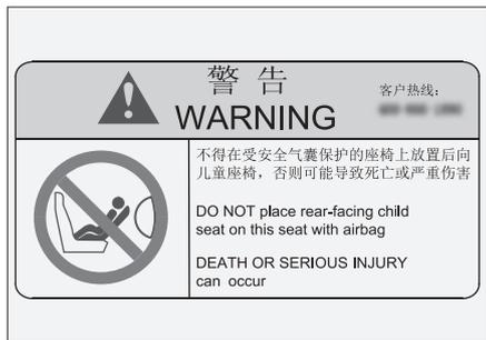
该标贴位于副驾驶侧遮阳板上，用于提示您本车配备有正面安全气囊，请注意相关事项。
