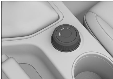
旋转旋钮可以切换驱动模式，包含 2H、4H、4L 模式。
