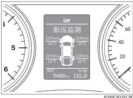
向上或向下拨动方向盘调节轮，将行车电脑界面切换为胎压监测界面，可以实时查看四个在用轮胎的压力和温度信息。
