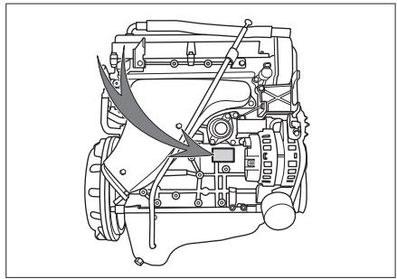
发动机编号刻印在发动机气缸体上面，位置如上图所示。
