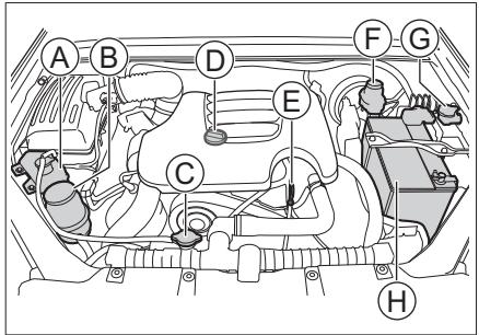
Ⓐ 冷却液溢水罐（发动机系统）
