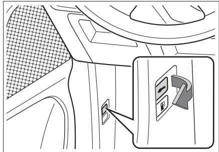
2. 将手伸进缝隙中，沿箭头方向拨动锁扣并抬起机舱盖，机舱盖将自动上升至打开状态。
