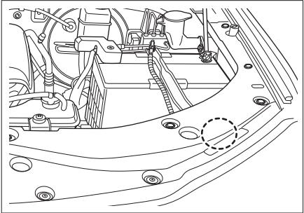
位于机舱蓄电池旁，是一组已密封的线束，可为额定功率小于或等于 300 瓦的附件提供 12 伏的直流电源。启动发动机，按压机舱电源开关即可使用。
