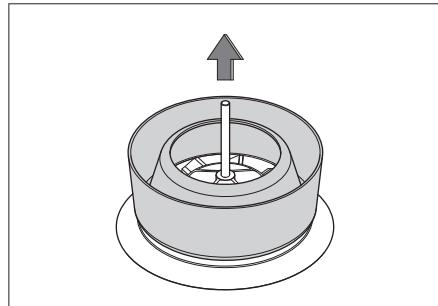
4. 将集沙杯清理干净。按与拆卸相反顺序将集沙杯复原。
