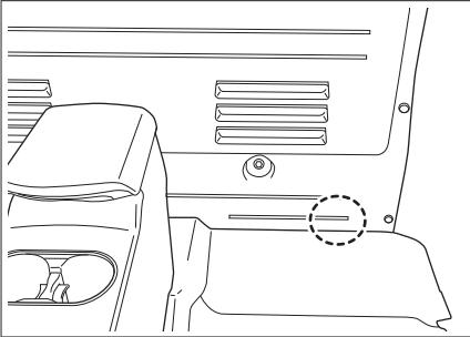
位于驾驶员后方地板附近（需拆开后围护面），是一组已密封的线束，可为额定功率小于或等于 50 瓦的附件提供 12 伏的直流电源。打开点火开关即可使用。
