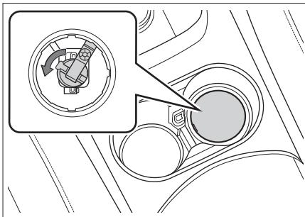
4. 提起绳索，拉升手柄至顶部后，顺时针旋转 P 挡解锁拉索手柄，会有轻微“啪”的一声，表示手柄位置已固定，变速器处于 P 挡解锁状态。此时车辆发出报警声，仪表显示“变速器 P 挡位置故障”。此时，变速器处于 N 挡状态。
