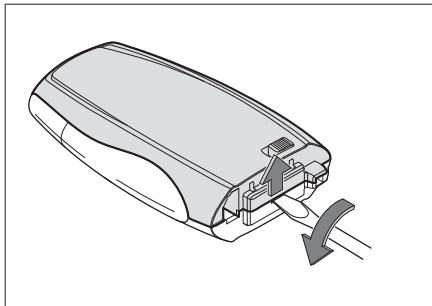
3. 取出旧电池，将新电池装入槽内。
