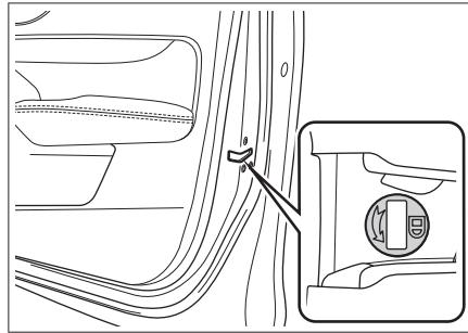
副驾驶员侧车门配有机门紧急锁止装置。
