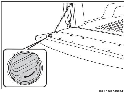
将货箱门锁开关旋转至【关】位置，可锁止货箱门，拉动货箱门把手将无法打开货箱门。
