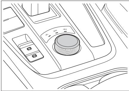
旋转四驱模式旋钮，可切换 2H、4H、4L 模式。当选择某个模式时，对应的指示灯会闪烁。待切换完成后，指示灯常亮。
