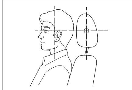
当您将头枕中心高度调整到与耳朵上部平齐时，头枕才能发挥最大的保护作用。
