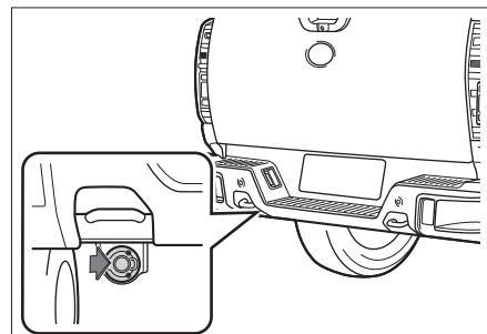
挂车取电口（连接器）位于车辆左侧拖车钩附近，按照图示箭头方向即可开启取电口盖。
