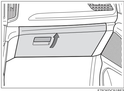
拉动储物箱上的扣手并向下翻转，即可打开储物箱。
