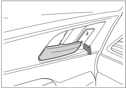
在车门锁止状态下，拉动驾驶员侧车门内扣手，可直接打开车门；拉动乘员侧车门内扣手可解锁车门，再拉动一次可打开车门。
