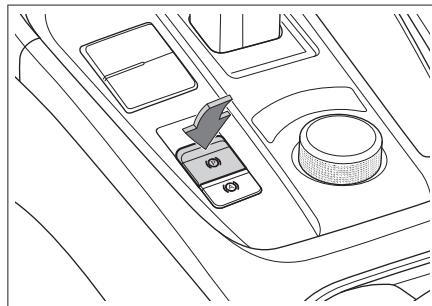
点火开关处于 ON 模式，踩下制动踏板，按压 EPB 开关，即可释放驻车制动。此时，组合仪表上的 (P) 指示灯熄灭。
