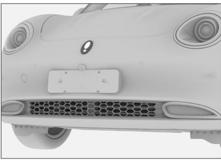
主动进气格栅在优先满足车辆散热需求的前提下，进行格栅叶片开启角度的控制，降低车辆高速行驶过程中的阻力，降低能耗，同时提升车内人员的舒适性。
