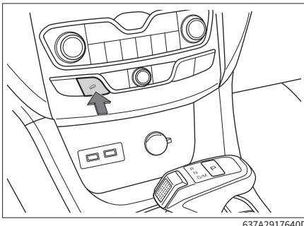
点火开关处于 ON 模式或发动机运转时，按压按钮，可以开启或关闭 HDC。
