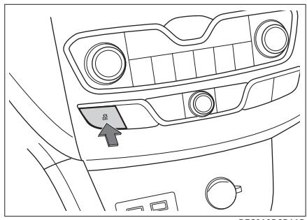
车辆启动后，按压 ESC 关闭按钮，组合仪表上的 ESC 关闭指示灯点亮，表示系统已关闭；再次按压，可重新开启 ESC。
