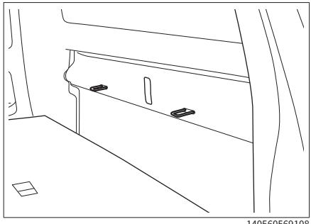
后排座椅靠背的后侧有 2 个儿童座椅上拉带固定点。
