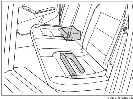
充气泵和补胎液放置在右侧后排座椅的后面；折叠后排座椅靠背即可看到。
