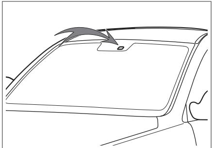
雨量光线传感器位于车内前风窗玻璃顶部中间位置，靠近内后视镜。
