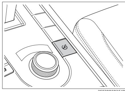
点火开关处于 ON 模式时，按压
