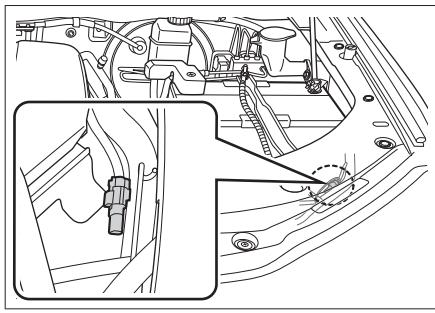
外接电源位于机舱蓄电池旁，可为额定功率小于或等于 300 瓦的附件提供 12 伏的直流电源。启动发动机，按压外接电源开关即可使用。
