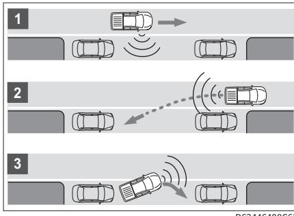
半自动泊车辅助系统通过传感器识别合适的停车位并自动控制车辆转向系统，使驾驶员无需操控方向盘，仅需按照组合仪表上的提示信息操控车辆，即可驶入停车位。
