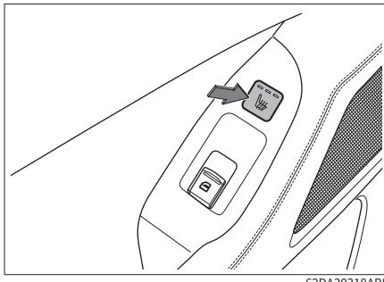
后排车门上各有一个座椅加热开关，可分别对后排座垫的左、右两侧进行加热。
