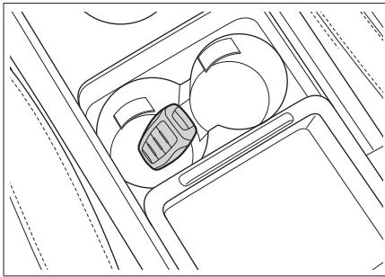
智能钥匙亏电等情况造成车辆提示“钥匙是否在车内”时，将钥匙放入杯座内带有标识的位置，执行发动机启动操作，即可启动发动机。如还无法启动发动机，请立即联系服务商。
