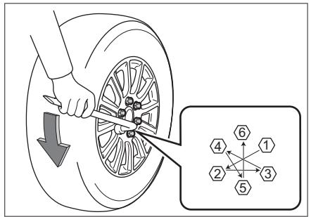
按图中指示顺序，利用车轮螺母扳手，逆时针拧动螺母，直到螺母能够用手拧动，暂时不要取下螺母。
