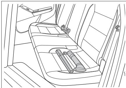
千斤顶放置在右侧后排座椅座垫的后面；折叠后排座椅靠背即可看到。（▷ 第 49 页）
