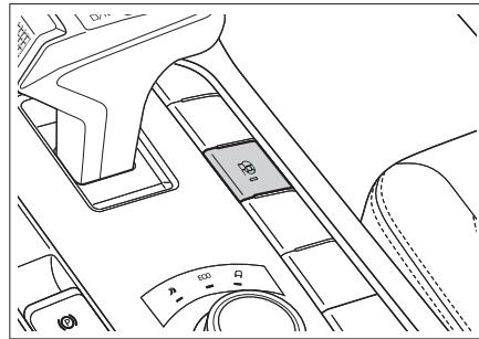
车辆在 D 挡以低于 30 公里/小时的车速行驶时，按压
