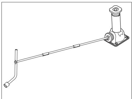
将备胎升降器摇杆和车轮螺母扳手组合成上图所示形式，然后将备胎升降器摇杆插进千斤顶端孔中。
