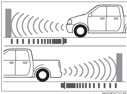
防撞雷达是一种雷达探测装置。在泊车时，通过传感器检测车辆的前方和后方是否有障碍物以及障碍物距离的远近，并用声音提示，从而辅助驾驶员安全、轻松地泊车。
