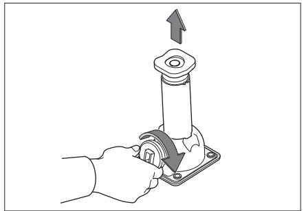
顺时针拧动千斤顶的调整旋钮，使千斤顶的高度接近车身的举升位置。
