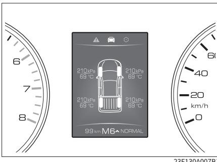
按压方向盘上的 ◀ 或 ▶ 按钮，将仪表切换至行驶数据界面，然后按压 ▲ 或 ▼ 按钮，将行驶数据界面切换为胎压监测界面，可以实时查看四个在用轮胎的压力和温度信息。
