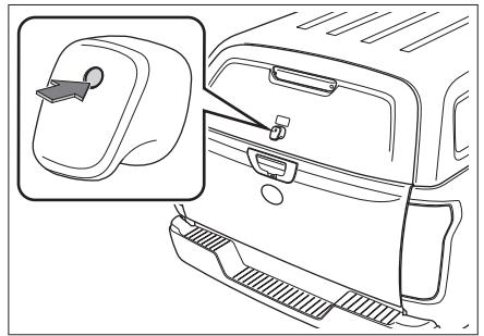
驾驶员侧车门为解锁状态时，按压防雨棚盖微动开关，然后手动抬起防雨棚盖。
