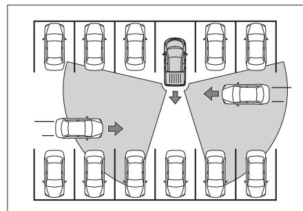
倒车侧向辅助功能通过传感器对外后视镜视野盲区内的运动车辆进行探测，并在车辆倒车有风险时进行报警，以提示驾驶员安全驾驶。
