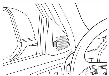
当车辆停止后，系统探测到相邻两侧车道有正在接近的车辆、自行车等，并在本车开门有风险时，点亮相应侧的报警灯。如果此时车上乘员继续打开车门，报警灯变为闪烁，且伴有声音报警，提示您继续开门存在危险。
