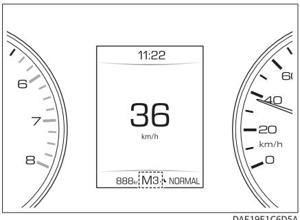
点火开关处于 ON 模式时，仪表上的信息中心将显示当前挡位信息。
