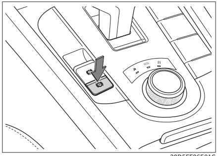
当车辆在坡上、遇见红灯或行驶走走停停时，自动驻车（AVH）可使驾驶员无需长时间踩下制动踏板，或频繁施加电动驻车制动。使驾驶员驾车更舒适，还能降低车辆溜车的风险。
