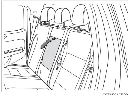
向外拉动拉绳，可将后排扶手放倒，为后排乘员提供肘部支撑，使手臂更舒适。
