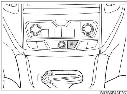
› 电源开关位于 ON 模式或车辆启动后，按压按钮，可开启或关闭全景环视影像。
