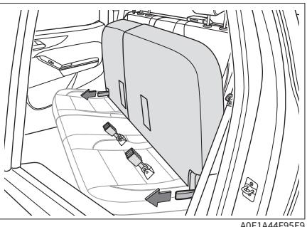
1. 将安全带锁扣旋转调整到最低位置，确保安全带锁扣可以顺利进入座垫卡槽，以免影响安全带的正常使用。
