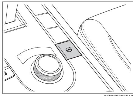
点火开关处于 ON 模式时，按压
