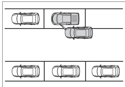
当车辆静止或以低速（≤5 公里/小时）向前方行驶时，开门预警功能通过传感器对相邻两侧车道后面接近的车辆、自行车等进行探测，并在本车开门有风险时进行报警，以提示驾驶员此时请勿开门。
