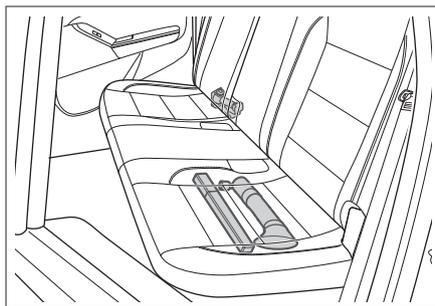
千斤顶放置在右侧后排座椅座垫的后面；折叠后排座椅靠背即可看到。
