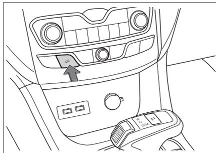
点火开关处于 ON 模式或发动机运转时，按压按钮，可以开启或关闭 HDC。
