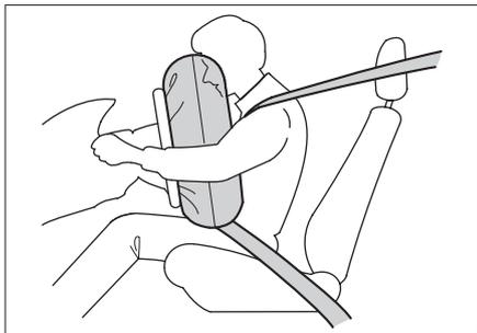
如果发生中等至严重程度的正面碰撞事故，传感器会感知到车辆正在急剧减速，控制装置会立即使安全气囊在瞬间强力起爆。
