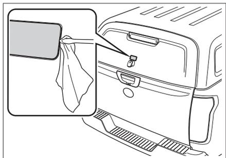
2. 将防雨棚钥匙插入锁孔内，转动钥匙可解锁防雨棚盖。
