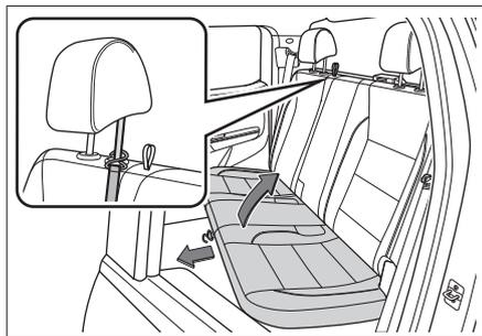
1. 拉动座垫中部的解锁拉手，并将解锁后的座垫向上翻起可将座垫折叠。
