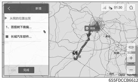
在左侧列表里触摸选择一个途经地，地图中心点会移动到所选途经地的位置。触摸【删除】按钮，可以删除路线上的途经地。
