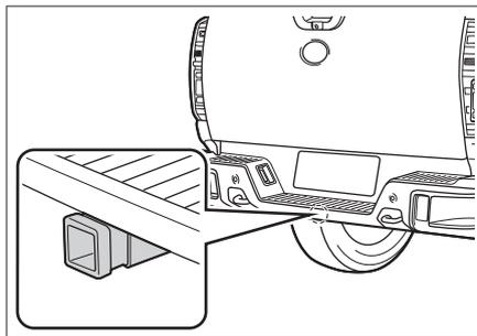
牵引装置安装点位于车辆后部纵梁后段中心处。
