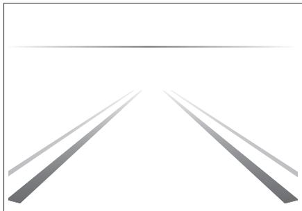
开启车道偏离预警系统后，组合仪表上将显示车道分界线。
