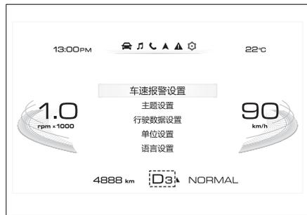
点火开关处于 ON 模式时，组合仪表上的信息中心将显示当前挡位信息。
