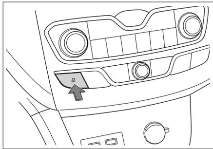
车辆启动后，按压
