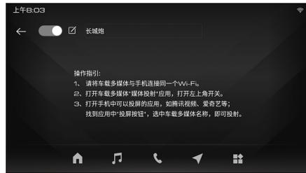
触摸开启媒体投射开关后，请根据提示步骤进行媒体投射。可重命名本机名称。
