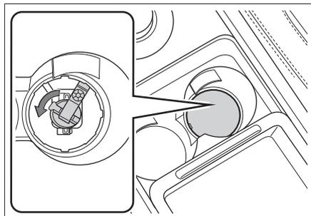
5. 提起绳索，拉升手柄至顶部后，顺时针旋转 P 挡解锁拉索手柄，会有轻微“啪”的一声，表示手柄位置已固定，变速器处于 P 挡解锁状态。此时车辆发出报警声，仪表显示“变速器 P 挡位置故障”。此时，变速器处于 N 挡状态。
