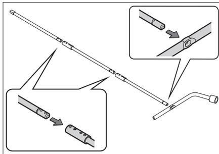
将备胎升降器摇杆前段、中段、后段及车轮螺母扳手组合成如图所示的形式。
