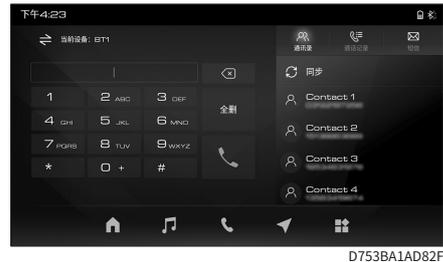
当同时连接两部手机时，触摸 **⇌** 按钮，可更换当前连接手机。
