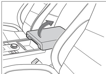
前排座椅扶手下面设有储物盒。欲使用时，直接向上翻转座椅扶手即可打开。
