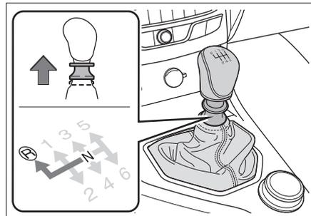
4. 将换挡杆切换至 R 挡，释放解锁装置。
