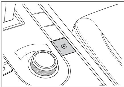
点火开关处于 ON 模式时，按压
