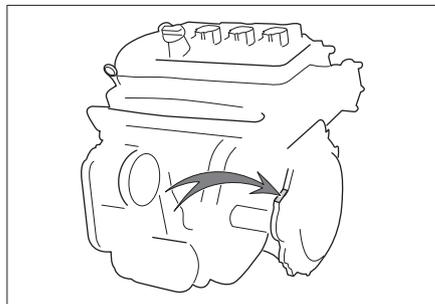
发动机编号刻印在起动机上方气缸体上面，位置如图所示。
