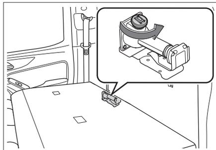
3. 千斤顶使用完毕后，按照与取出相反的顺序将千斤顶放回原位，并确认其已固定牢固。
