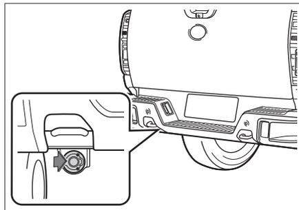
挂车取电口（连接器）位于车辆左侧拖车钩附近，按照图示箭头方向即可开启取电口盖。
