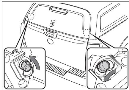
如图，拨动防雨棚盖的左右解锁装置后，即可手动打开防雨棚盖。
