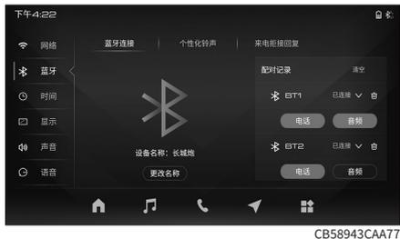
在列表里可选择连接两个已配对设备的电话功能，连接一个已配对设备的音频功能。
