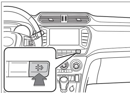
5. 开启空调（A/C 处于开启状态），DPF 即可进入再生过程，此时，发动机转速将自动上升到 2000 转/分左右，同时文字提示“颗粒捕集器正在自洁”。
