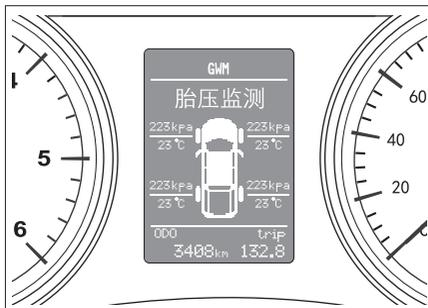
向上或向下拨动方向盘调节轮，将行车电脑界面切换为胎压监测界面，可以实时查看四个在用轮胎的压力和温度信息。
