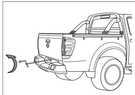
将备胎升降器摇杆伸入车底，插入备胎绞盘的凹槽内，然后逆时针旋转车轮螺母扳手以降低备胎。
