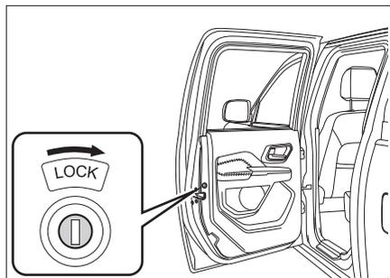
将机械钥匙插入锁孔，按图示方向旋转，即可开启儿童锁。反向旋转可关闭儿童锁。
