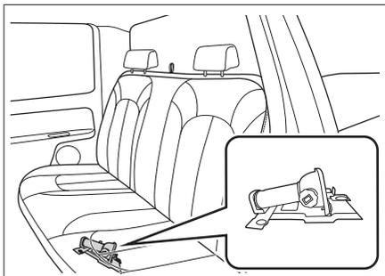
千斤顶放置在后排座椅左侧座垫下面。
