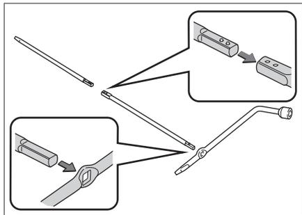
将备胎升降器摇杆前段和中段及车轮螺母扳手组合成如图所示的形式。
