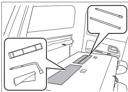
随车工具包、三角警告牌、车轮螺母扳手和备胎升降器摇杆放置在后排座椅靠背后的布袋内。向上拉起后排座椅上的拉环，将后排座椅放倒后，即可看到。
