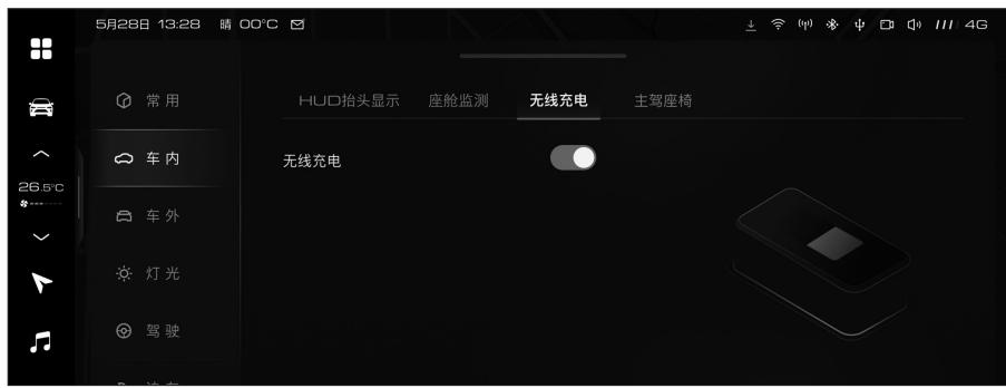
开启手机无线充电功能后，确保车门已关好，将点火开关切换至 ON 模式或启动车辆，即可对放置在充电区域的手机充电。
