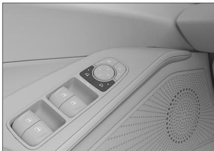
同时按下 2 个外后视镜选择按钮，外后视镜将自动折叠。再次按压，外后视镜将自动展开。
