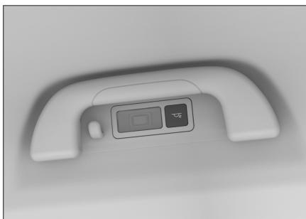
按压 左侧顶灯开关或 右侧顶灯开关，可以开启或关闭相应的顶灯。
