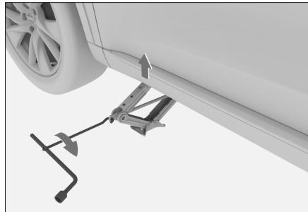
将千斤顶、千斤顶调节杆和车轮螺母扳手组合成上图所示形式，顺时针拧动千斤顶，使轮胎稍微离开地面。
