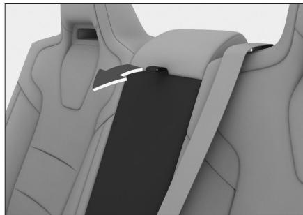
向外拉动拉绳，可将后排扶手放倒，为后排乘员提供肘部支撑，使手臂更舒适。
