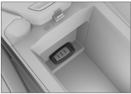
若车辆提示“钥匙是否在车内”时（例如：智能钥匙亏电；门护板或后保险杠严重损坏等情况），打开前排扶手储物盒，将智能钥匙放入储物盒内『
