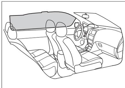
帘式安全气囊位于顶棚下沿，在立柱上标有气囊标识。帘式安全气囊是对安全带的补充，发生侧面碰撞时，帘式安全气囊会降低车内乘员的头部伤害，防止再次碰撞。
