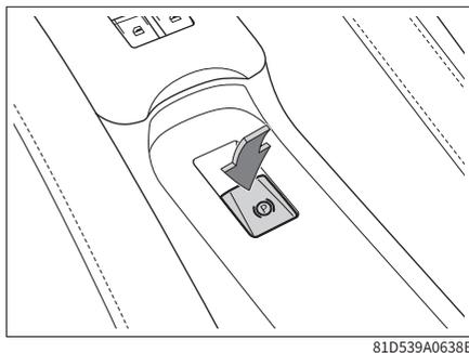
电源开关处于 ON 模式，踩下制动踏板，按压 EPB 开关，即可释放驻车制动。此时，组合仪表上的 (P) 指示灯熄灭。
