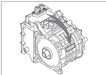
驱动电机编号刻印在电机壳体上，位置如图所示。
