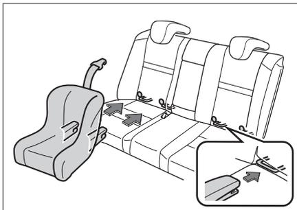
4. 将上拉带紧固在对应的上拉带固定点上，注意不要卷曲上拉带。固定时，务必将上拉带从座椅头枕下方穿过。
