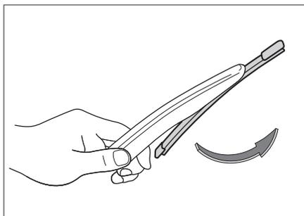
3. 安装新雨刮片，并将雨刮放回回到风窗玻璃上。
