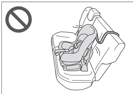
否则儿童座椅无法牢固固定，在紧急制动或发生碰撞时，可能会造成重伤甚至死亡。
