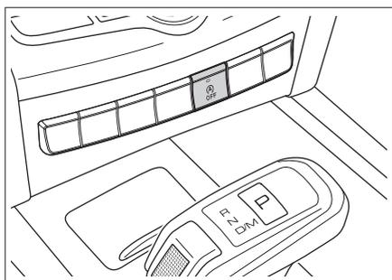
点火开关处于 ON 模式时，按压
