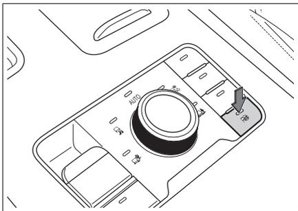
启动车辆后，车速低于 30 公里/小时，按压 P 按钮，全自动泊车辅助系统激活。系统激活后依据多媒体显示屏提示操作即可完成自动泊车。
