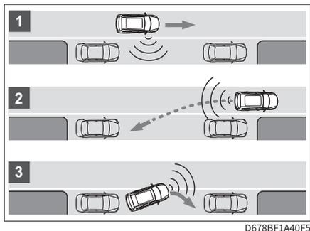
全自动泊车辅助系统通过传感器识别合适的停车位并自动控制车辆，驾驶员仅需按照系统提示操控车辆即可驶入、驶出停车位。
