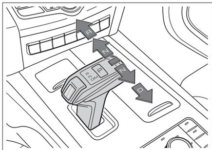
将换挡杆朝所需的方向短促推动，必要时超过压力点，松开换挡杆自动返回到中间位置。
