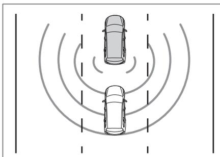
当本车道内其他车辆等目标接近本车且有碰撞风险时，后碰撞预警功能进行报警，以提示驾驶员有危险目标接近，同时可以提示后方车辆安全行驶。
