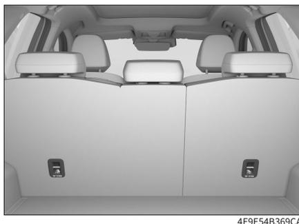
后排座椅靠背的后侧有 2 个儿童座椅上拉带固定点。
