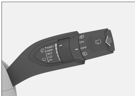
垂直方向盘向上拉起雨刮控制组合开关，前雨刮将使用风窗洗涤剂刮刷前风窗玻璃。
