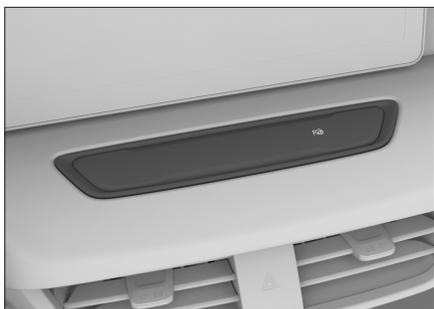
启动车辆后，车速低于 30 公里/小时，触摸按钮，全自动泊车辅助系统激活。系统激活后依据多媒体显示屏提示操作即可完成自动泊车。
