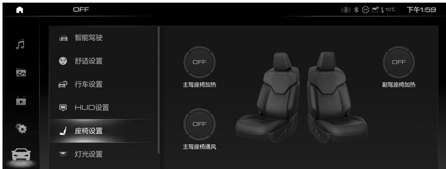
反复触摸界面上的座椅加热（或座椅通风）按钮，可设置相应的座椅加热（或座椅通风）功能的挡位或关闭。
