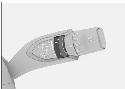
旋转调节旋钮可以改变间歇时间，从而改变前雨刮在间歇刮刷挡位时的刮刷频率。
