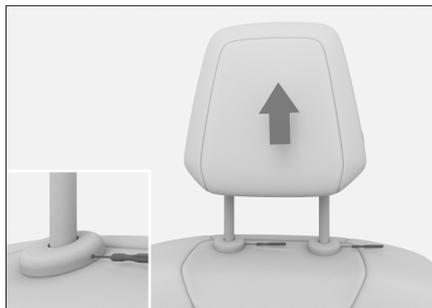
将头枕调高，一人用 2 个较细的螺丝刀同时按压锁孔，另一人可向上拔出头枕。
