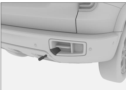
2. 将拖车钩顺时针拧入孔中，并用车轮螺母扳手进行紧固。
