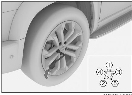
利用车轮螺母扳手，按照图示顺序逆时针稍微拧松螺栓（大约1圈）。
