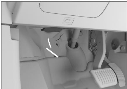
2. 略微抬起机舱盖，将手伸进缝隙中沿箭头方向拨动机舱盖锁扣手，即可打开机舱盖。
