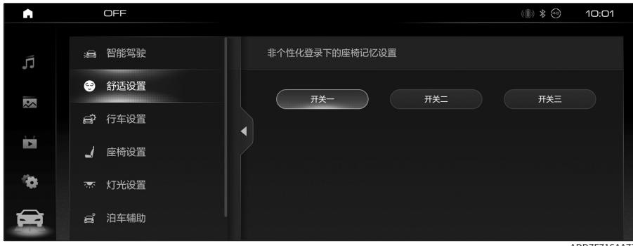
将驾驶员座椅调节到所需位置，长按屏幕上的任一设置开关可以存储当前位置，同时提示“记忆成功”。
