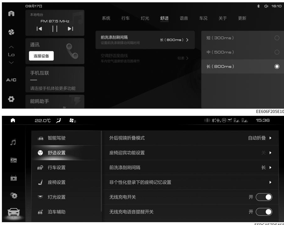
触摸【前洗涤刮刷间隔】按钮，可以设置自前雨刮洗涤电机开始工作至前雨刮开始刮刷的时间间隔。
