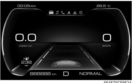
开启紧急车道保持功能后，组合仪表上将显示车道分界线。
