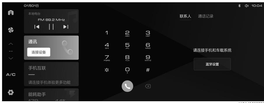
触摸【蓝牙设置】按钮，切换至蓝牙设置界面，可进行蓝牙相关设置和配对连接。
