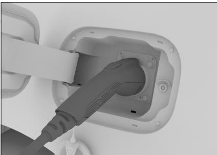
连接正常后，控制盒上电源指示灯及仪表上的充电连接指示灯点亮。
