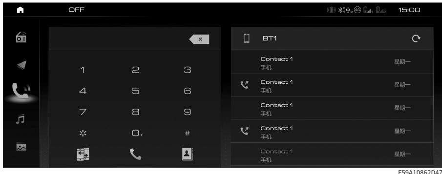
界面左侧显示键盘。右侧显示通话记录，触摸 C 更新按钮，可更新通话记录。
