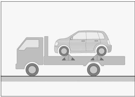
禁止使用吊起型载货卡车进行拖曳，否则会损坏车身。
