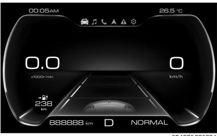
开启车道保持辅助功能后，组合仪表上将显示车道分界线。
