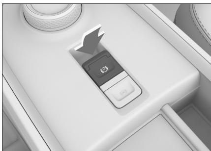
车辆电源处于 ON 模式时，踩下制动踏板，按压 EPB 开关，即可释放驻车制动。此时，组合仪表上的 (P) 驻车制动指示灯熄灭。
