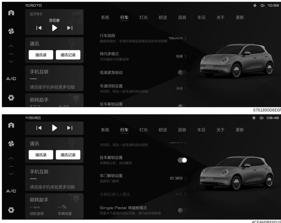
触摸开关可开启或关闭对应的功能。触摸 > 按钮，可弹出对应设置窗口。
