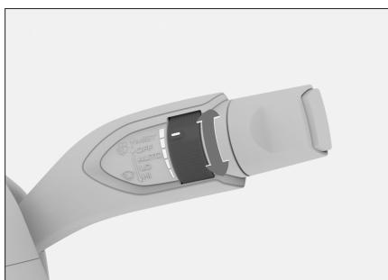
旋转调节旋钮可以改变雨量光线传感器对雨量的敏感度，从而改变前雨刮在自动刮刷挡位时的刮刷频率。
