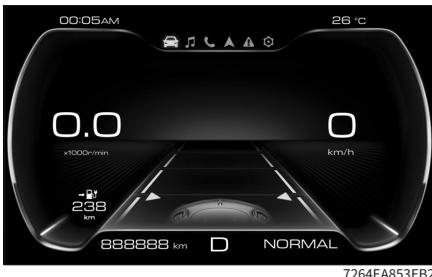
开启车道居中保持功能后，组合仪表上将显示车道分界线。
