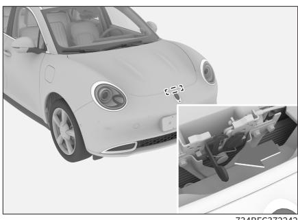
3. 将支撑杆从卡槽中取出，然后将前端插入机舱盖的凹槽里，以固定打开的机舱盖。
