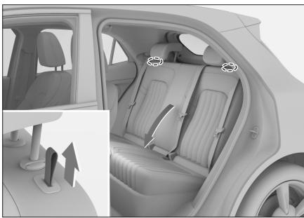
拉起靠背顶部解锁扣手，可将解锁后的靠背向前折叠。
