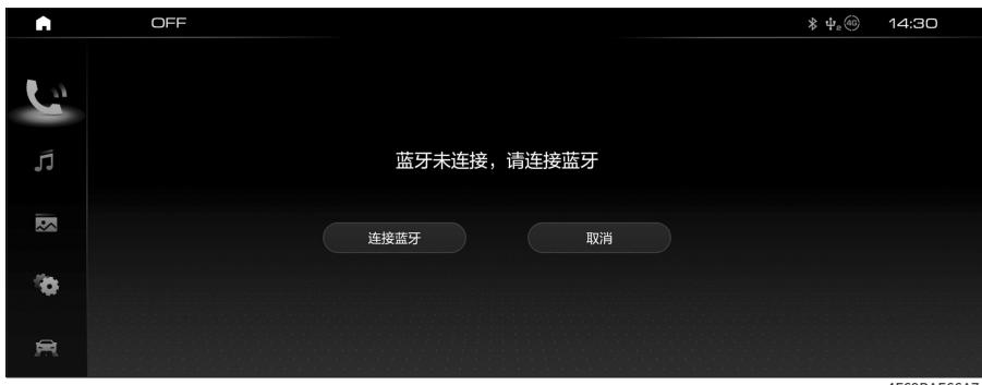
触摸【连接蓝牙】按钮，切换至蓝牙设置界面，可进行蓝牙相关设置及配对。
