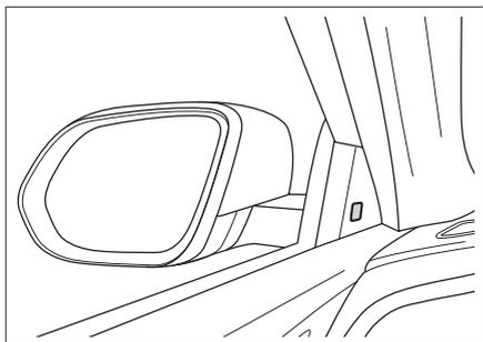
行车过程中（车速超过 15 公里/小时），当系统探测到本车外后视镜视野区内存在车辆或相邻车道后方有驶近的车辆时，相应侧的报警灯点亮。如果此时开启同侧的转向灯，报警灯变为闪烁，且伴有声音报警，提示您继续变更车道存在危险。
