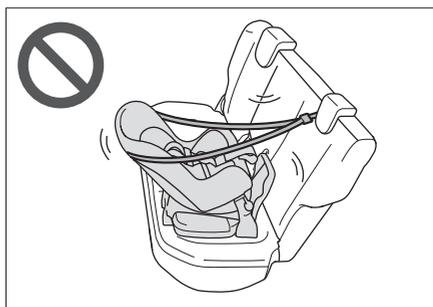
否则可能由于头枕碰触上拉带而使其松弛，在紧急制动或发生碰撞时导致儿童座椅转动，可能会造成重伤甚至死亡。
