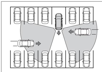
倒车侧向辅助功能分为倒车侧向警告和倒车侧向制动功能。
