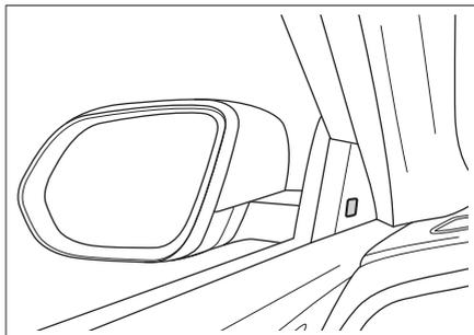
倒车过程中，当系统探测到本车的侧后方有车辆接近且可能发生碰撞时，相应侧的报警灯闪烁，且伴有声音报警，提示您继续倒车存在危险。
