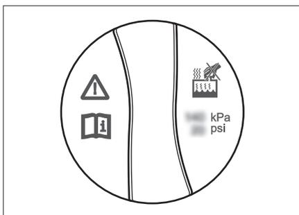
该标贴位于溢水罐盖上，用于提示您发动机和散热器处于过热状态时，不要打开溢水罐盖。否则，灼热的液体和蒸汽会在压力下冲出，发生烫伤事故。
