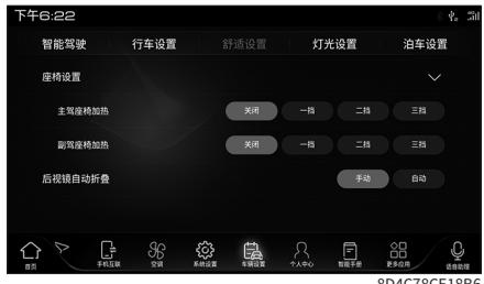
触摸界面上的相应按钮, 可调节相应座椅的加热挡位。
