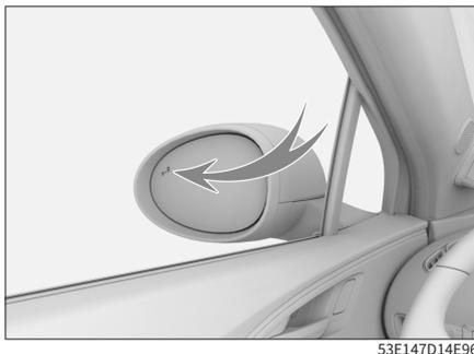
倒车过程中，当系统探测到本车的侧后方有车辆接近且可能发生碰撞时，相应侧的报警灯闪烁，且伴有声音报警，提示您继续倒车存在危险。
