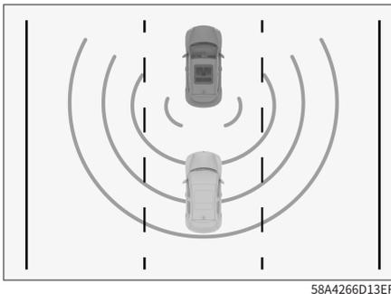
当本车道内后方其他车辆等目标接近本车且有碰撞风险时，后碰撞预警功能进行报警，以提示驾驶员有危险目标接近，同时可以提示后方车辆安全行驶。
