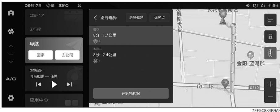
在左侧列表选择一个路线后，右侧地图显示该路线预览信息。可查看该路线规则下引导路径的概况，包括起点、终点、全程时间、全程距离。
