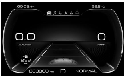
开启紧急车道保持功能后，组合仪表上将显示车道分界线。
