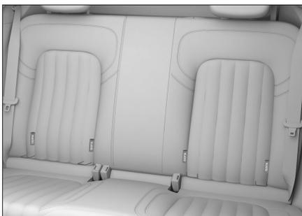
后排座椅靠背及座垫之间的缝隙处有 4 个儿童座椅下部固定点。
