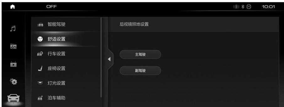
触摸屏幕上的按键，可开启或关闭相应外后视镜的照地功能。按键点亮，表示功能开启。
