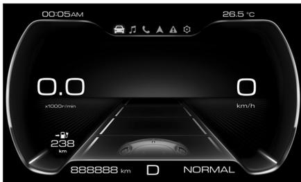
开启车道保持辅助功能后，组合仪表上将显示车道分界线。
