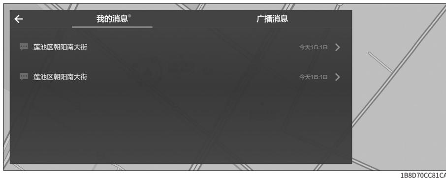
可以查看我的消息：手机端或网页端与车机端登录同一账号后，通过手机端或网页端高德地图分享到车机端的位置信息。
