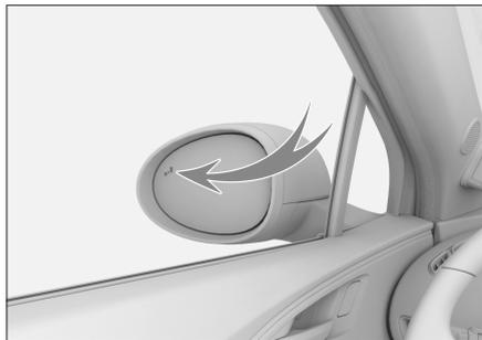
行车过程中（车速超过 15 公里/小时），当系统探测到本车外后视镜盲区内存在车辆或相邻车道后方有驶近的车辆时，相应侧的报警灯点亮。如果此时开启同侧的转向灯，报警灯变为闪烁，且伴有声音报警，提示您继续变更车道存在危险。
