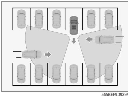
倒车侧向辅助功能分为倒车侧向警告功能和倒车侧向制动功能。
