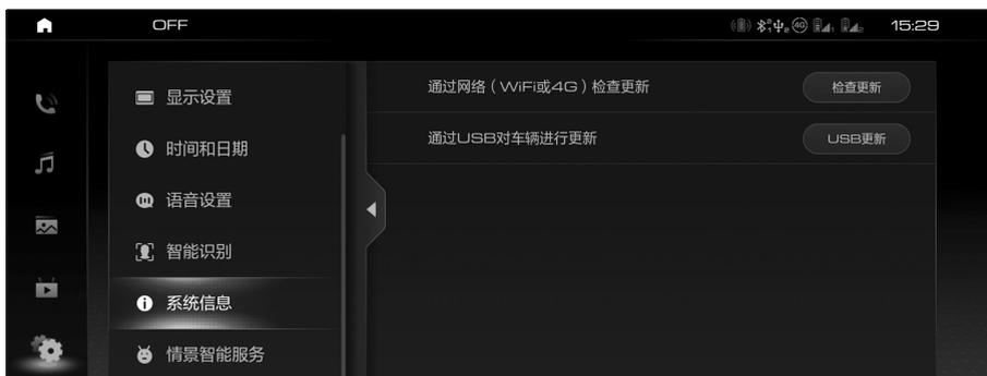
网络升级：触摸【检查更新】按钮，可根据界面提示进行系统升级。
