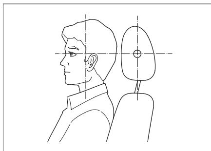
当您将头枕中心高度调整到与耳朵上部平齐时，头枕才能发挥最大的保护作用。
