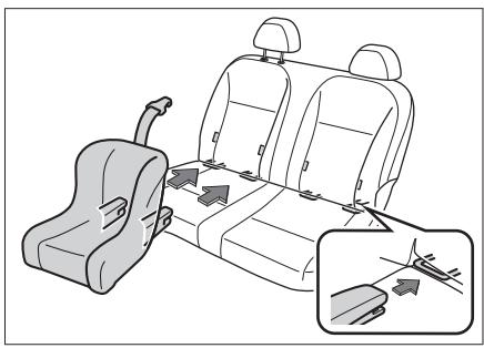
4. 将上拉带紧固在对应的上拉带固定点上，注意不要卷曲上拉带。固定时，务必必将上拉带从座椅头枕下方穿过。
