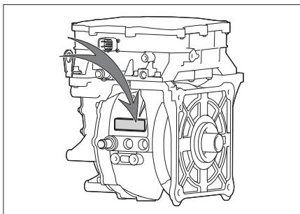
驱动电机编号刻印在其出水管上方，位置如图所示。
