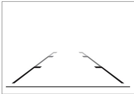
静态引导线指示车辆倒车时的直线引导路径，若有障碍物进入引导线的红线区域，须立即停止倒车，否则将发生碰撞事故。
