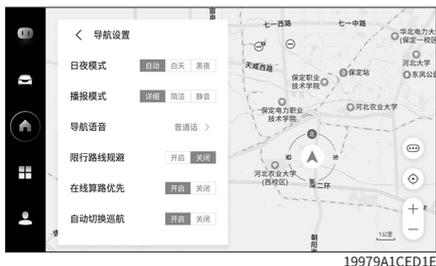
可对导航日夜模式、播报模式、导航语音、限行路线规避、在线算路优先、自动切换巡航进行设置。
