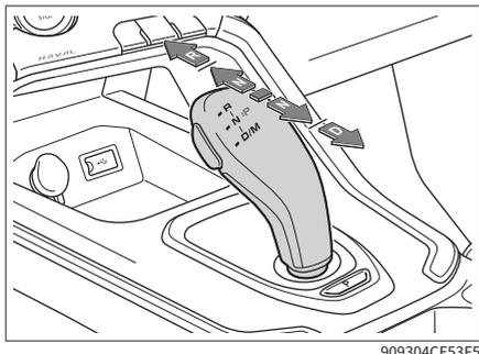
将换挡杆朝所需方向拨动，松开换挡杆自动返回到中间位置。
