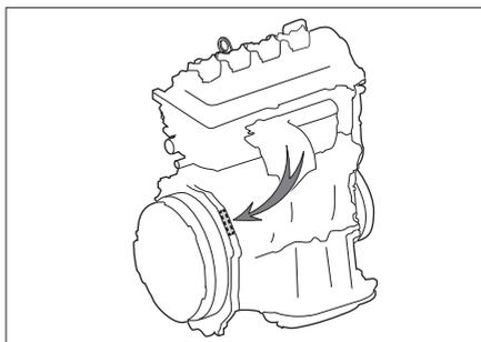
发动机编号刻印在发动机气缸体上，位置如图所示。
