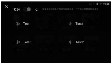
开启系统蓝牙后，显示搜索到的手机蓝牙名称，触摸设备名称，可根据提示进行配对连接。
