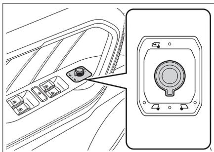
1. 旋转外后视镜调节旋钮选择左侧或右侧外后视镜。
