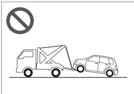
禁止使用吊起型载货卡车进行拖拽，否则会损坏车身。
