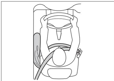
侧面安全气囊位于座椅靠背外侧衬垫内，在座椅靠背上标有气囊标识。侧面安全气囊是对安全带的补充，发生侧面碰撞时，侧面安全气囊会降低车内乘员的伤害，防止再次碰撞。
