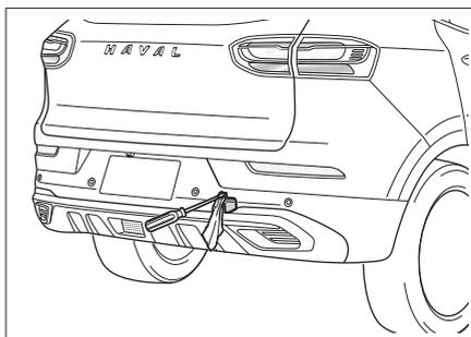
在拖车钩盖板缺口处，使用布包裹的平头螺丝刀，将盖板撬下。
