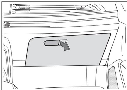
拉动储物箱上的扣手并向下翻转，即可打开储物箱。
