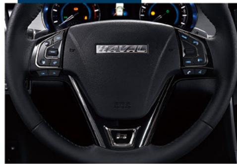
② 方向盘按键控制 + 方向盘拨片换挡
