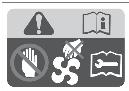
该标贴位于机舱前盖板上，用于提示您冷却风扇随时可能启动，切勿将手伸入风扇护罩。否则，风扇意外启动时，可能会造成严重人身伤害。
