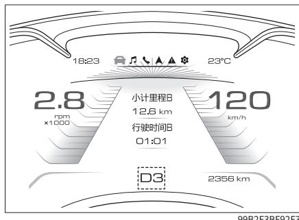
点火开关处于 ON 模式时，组合仪表上的信息中心将显示当前挡位信息。
